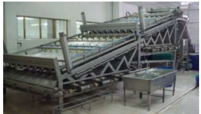
Hình 4.3.58. Máy phân cỡ tôm
